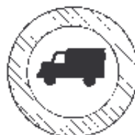
8 Accès interdit aux véhicules de transport de marchandises d'un poids total en charge supérieur à celui indiqué.
